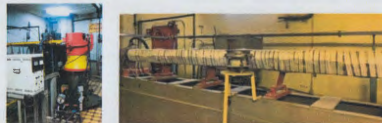
Рис. 2. Слева – третий клистронный пост после восстановления; справа – ускоряющая секция (без экранирующих кожухов) с протяженными компенсирующими катушками.
