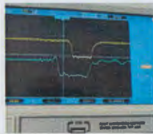
Рис. 4. Нижний луч осциллограммы – импульс восстановленного модулятора; верхний луч – огибающая СВЧ-импульса.
