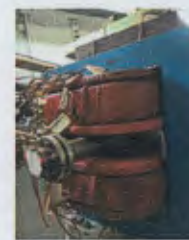
Рис. 7. Поворотный магнит параллельного переноса с дополнительными обмотками
